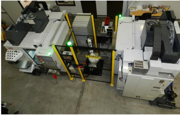
*Maximale Effizienz: Der Kawasaki Robotics RS010N bedient parallel zwei Werkzeugmaschinen.*
