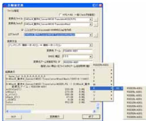
カワサキはロボットの位置変換ソフトを作成しました。あるロボットの各軸値教示点や各軸位置変数を他のカワサキロボットに変換することができます。例えば、設備更新などで新ロボットに置き換える際に、オフライン・シミュレータと併せて活用いただけます。使い方は簡単で、変換元のデータを準備し、変換先機種を指定して実行すると、ロボットが届かない位置はNG、届く点はOKと表示されます。
