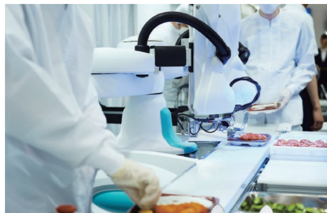
多品種少量生産に適合し、安心・安全に人との協働が可能な双腕スカラロボット「duAro」。
