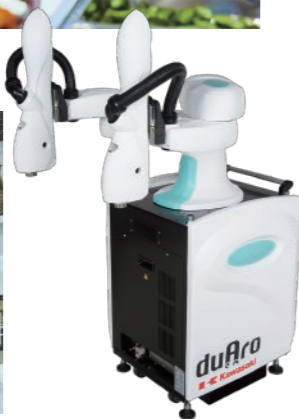
多品種少量生産に適合し、安心・安全に人との協働が可能な双腕スカラロボット「duAro」。
