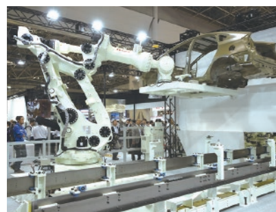
2015年12月、当社最大・可搬質量1トンの超重可搬ロボット「MG10HL」を発売。同年の国際ロボット展で車体を持ち上げる様子が披露された。
