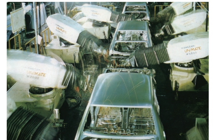
当時の自動車工場で稼働する「川崎ユニメート2000型」。
