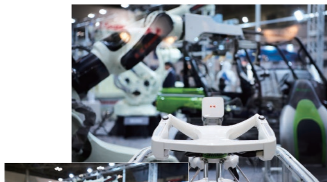
「Successor」の組立用コミュニケーター。作業に合わせて開発されたコミュニケーターを使って人とロボットが協働する。
