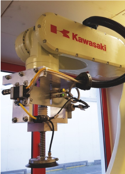
Der Vakuumgreifer nimmt die Farbeimer zuverlässig auf.
