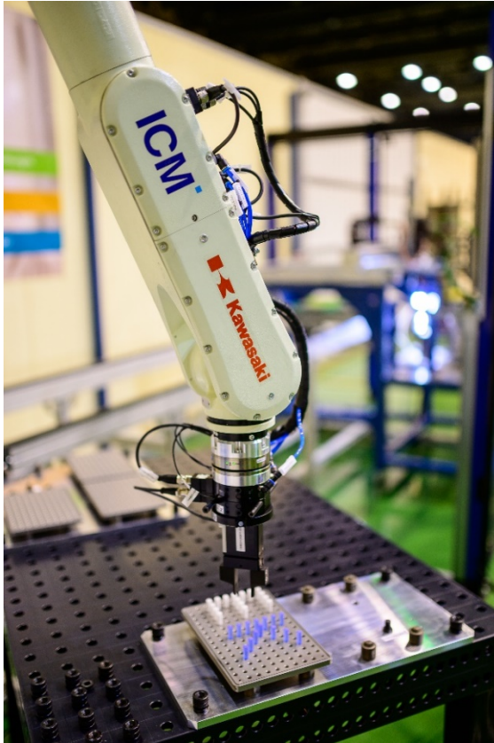
Der Kawasaki Robotics RS010L montiert die gewünschte Konfiguration von Steckbolzen auf eine bereitgestellte Lochplatte und handhabt diese zwischen Förderband und der mobilen Einheit.
